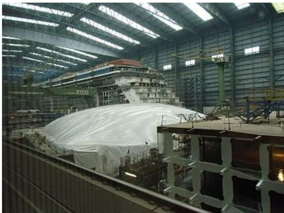
Der ganze Schiffbau ist heutzutage wie ein riesiges 3 Dimensionales Puzzles. Zuerst werden die Stahlplatten lasergenau zugeschnitten, dann werden die Versteifungsprofile darauf geschweißt, bevor dann die senkrechten Stahlteile darauf befestigt werden. Bereits jetzt werden die Rohrleitungen und Kabeltrassen an den Sektionen eingebaut. Sind mehrere Sektionen fertig, werden diese auf einander gesetzt und mit
